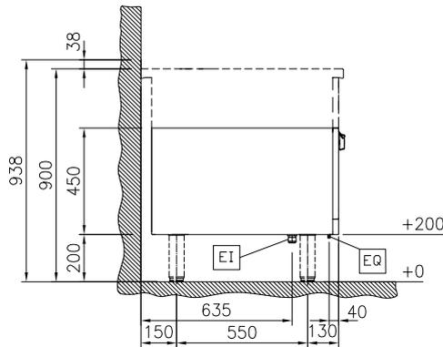
EI = Conexión eléctrica (energía)
